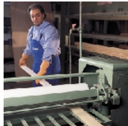
Untura con rodillo del ADESIVIL D3 para el acomplamiento de madera
