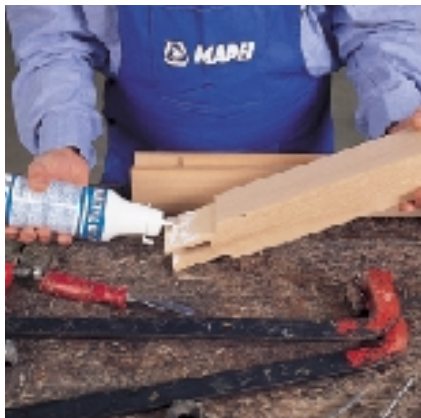
Encolado de cierres de madera en el exterior
