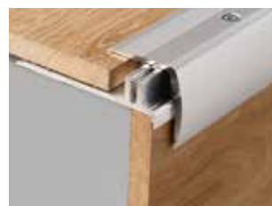
Cantonera de escalón, aluminio PGSTPSILVME250, 2500 x 30 mm Se adapta a suelos de 7 – 15 mm de espesor. Superficie: aluminio. Color: plateado.
