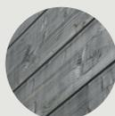
**DECOLORACIÓN:** Es una degradación debida a agentes abióticos, especialmente por los rayos UV, que provoca una decoloración de los pigmentos dando un aspecto grisáceo tanto a los productos tratados en autoclave como a los que no lo son. Este efecto puede ralentizarse con la aplicación de un lasur que proteja el material de los agentes atmosféricos.
